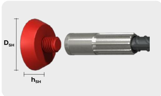
Gli elementi di fissaggio facilitano il mantenimento in posizione delle barre di armatura durante la prima tappa di betonaggio. A tale scopo si fissano alla cassera per mezzo di chiodi. La barra di armatura può quindi essere avvitata all'elemento di fissaggio e legata ai rimanenti ferri.
