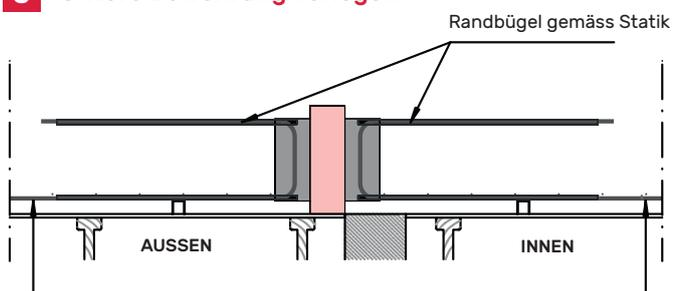
Untere Bewehrung einfügen und mit FIRIKA® Anschlusselement binden
