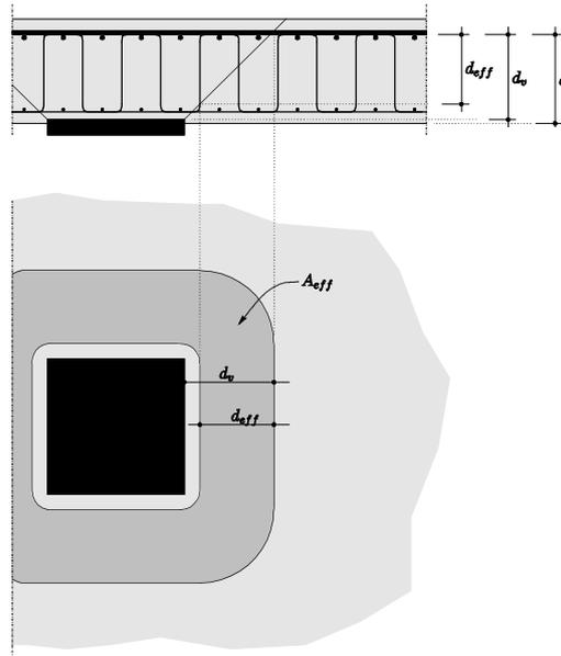
Abbildung 4 : Bruchkegel und Zone mit vollständig verankerter Durchstanzbewehrung
